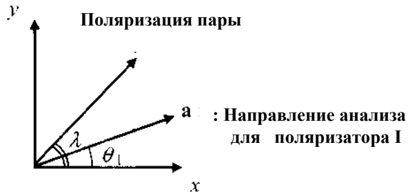
Рисунок 2 – Наивный пример. Каждая пара фотонов имеет «направление поляризации», определяемой углом \lambda , который является дополнительным параметром модели. Поляризатор I осуществляет измерение поляризации вдоль \mathbf{a} с углом \theta_1 относительно оси x .
